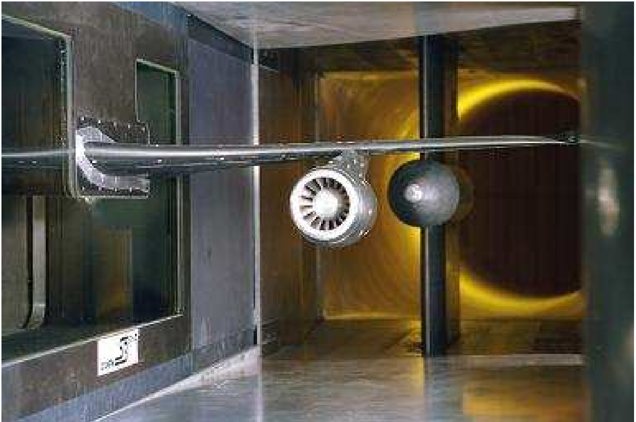
Fig. 9 - Veine de la soufflerie S3Ch avec maquette motorisée d'aile d'A340
