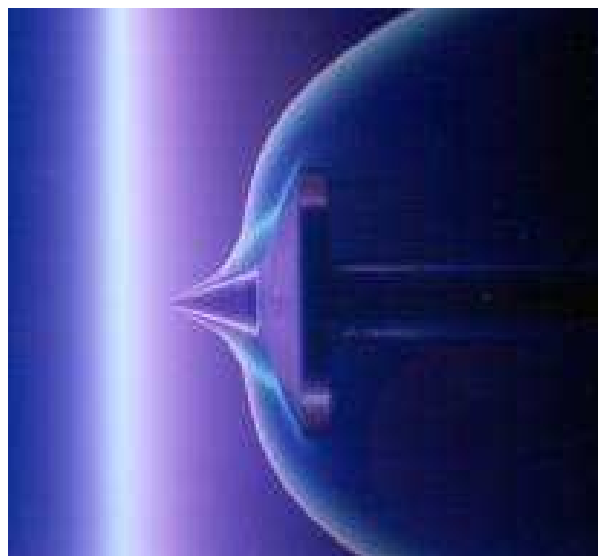
Fig. 12 - Vue en soufflerie hypersonique (Mach 10) des ondes de choc se formant devant une maquette double-cône (le vent vient de la gauche)
