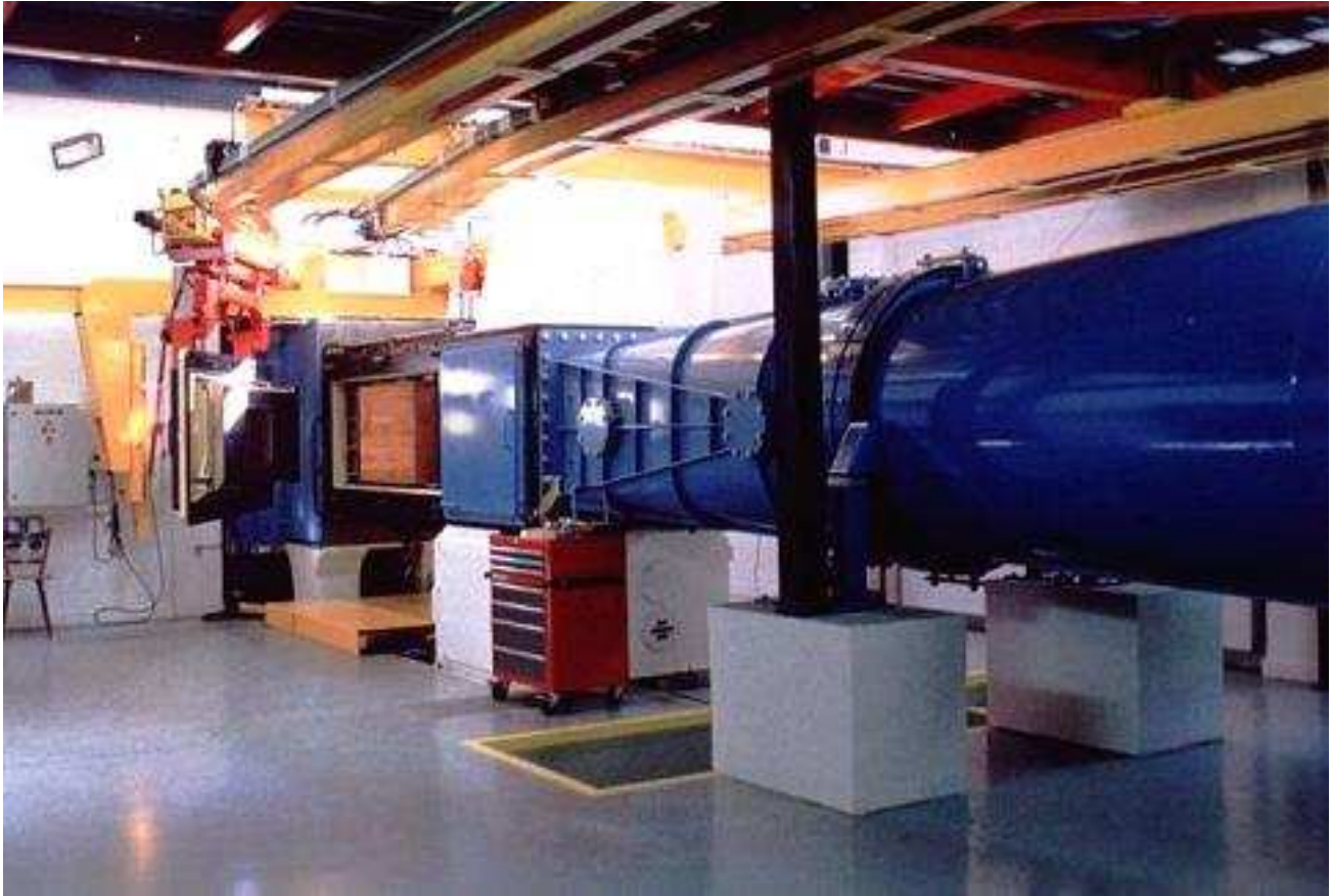
Fig. 8 - La soufflerie S3Ch du centre de Meudon après la rénovation de 1986.
