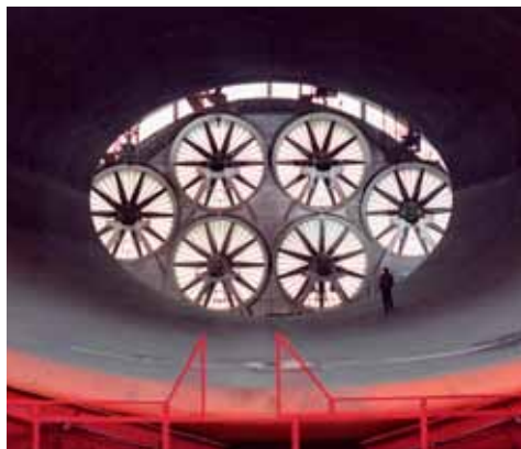
Conçue par Antonin Lapresle, la grande soufflerie de l'Onera à Meudon est de « type Eiffel » ; son diffuseur est long de 38 m. ©Onera.
